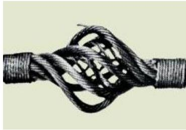
4. في حالة وجود نقص في قطر الواير بسبب الضغط عليه (Crushing) ويتم قياس القطر وفي حالة نقص القطر بمقدار يزيد عن ثلث (3/1) القطر الأصلي يتم إستبعاد الواير عن الخدمة.
